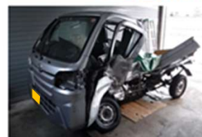
車両Aの変形状況
