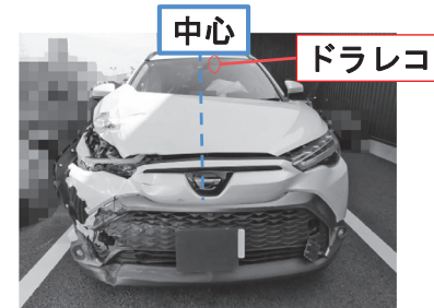
B車両の損傷状況
