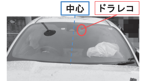
A車両のドライブレコーダの取り付け位置
