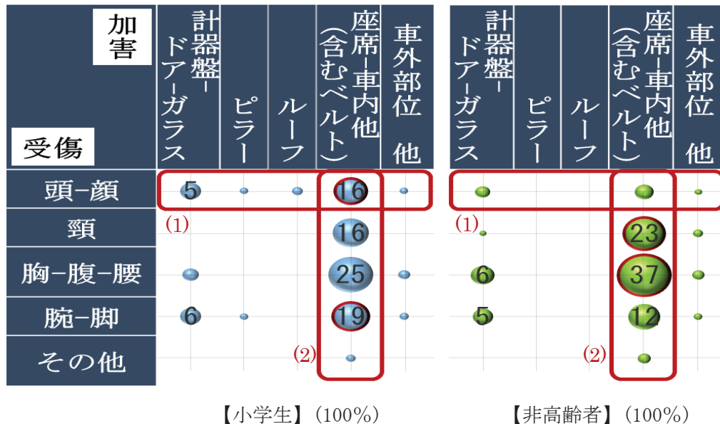
図4. ベルト「着用」の死亡重傷者の受傷・加害部位の構成割合(%) 2009~18年
