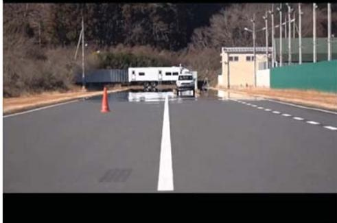
JNCAP「車線逸脱抑制装置」試験
