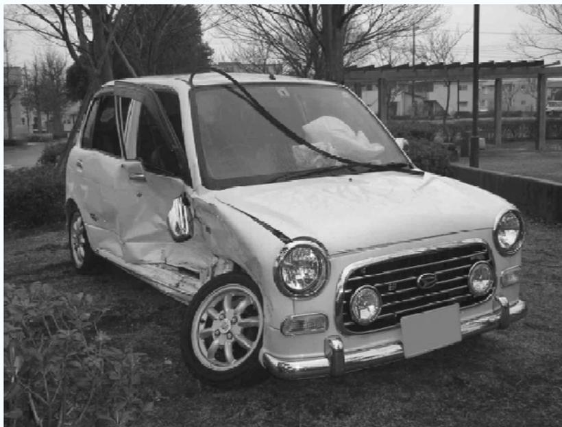
写真 A車の変形状況
