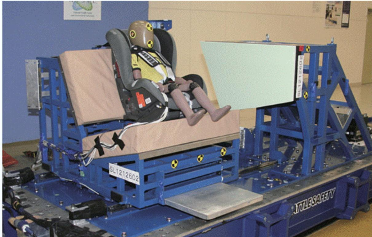
図 CRS側突スレッド試験の状況
