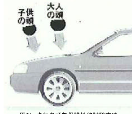
図31 歩行者頭部保護性能試験方法 (資料:NASVA)
