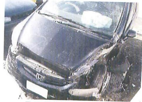
図 43 車両変形状況
