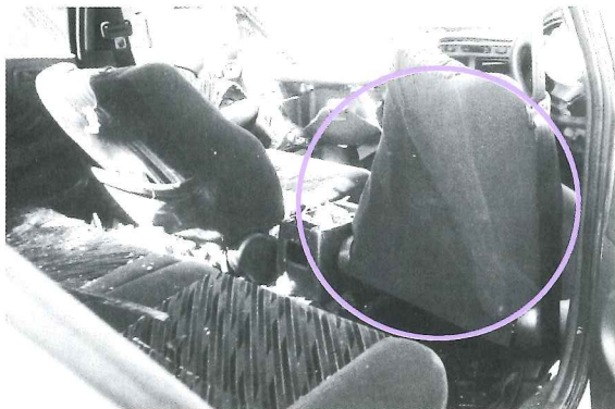
図24 A車の運転席シートバック変形状態
