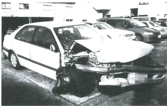
図12 A車の車体変形状況
