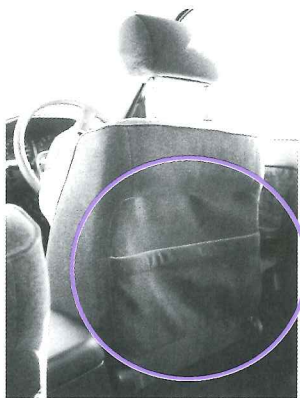
図14 A車の運転席シートバック変形状態
