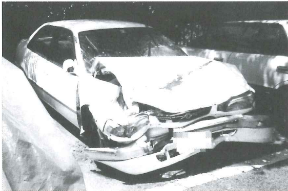
図7 A車の車体変形状況
