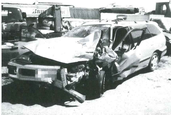
図22 A車の車体変形状況
