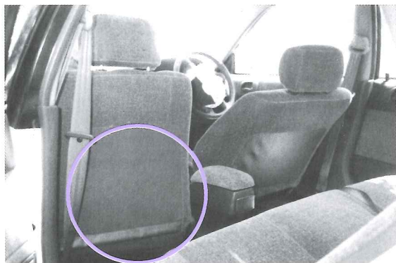
図9 A車の助手席シートバック変形状態
