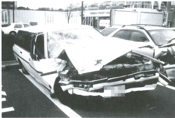
図17 B車の車体変形状況
