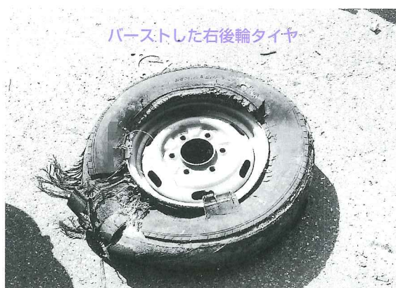
写真5 バーストした右後輪タイヤ
