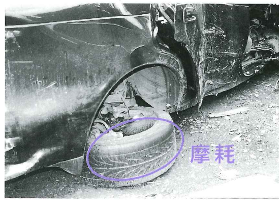
写真2 後輪タイヤ摩耗状態
