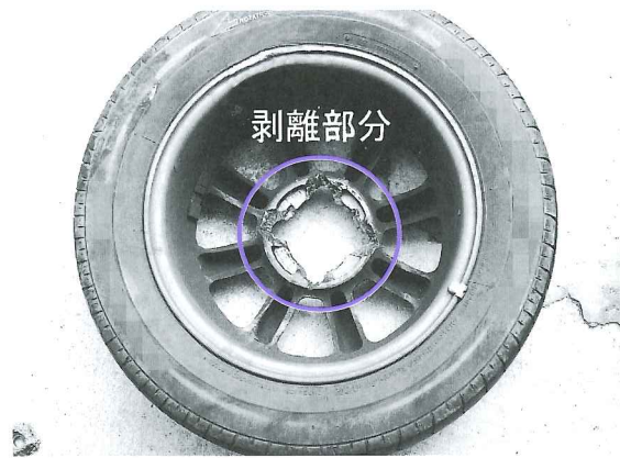
写真3 脱落した右後輪タイヤ
