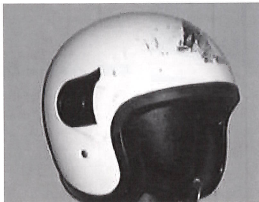
写真1 ヘルメットの損傷
