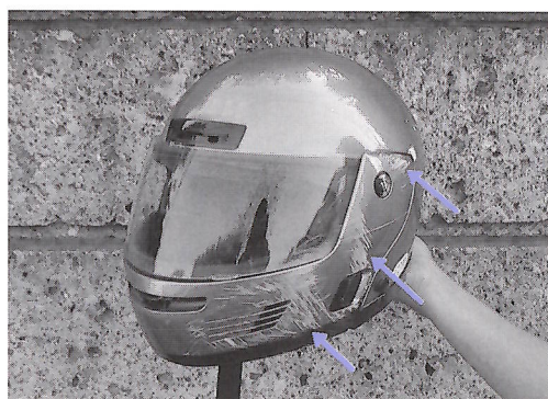
写真3 ヘルメットの損傷
