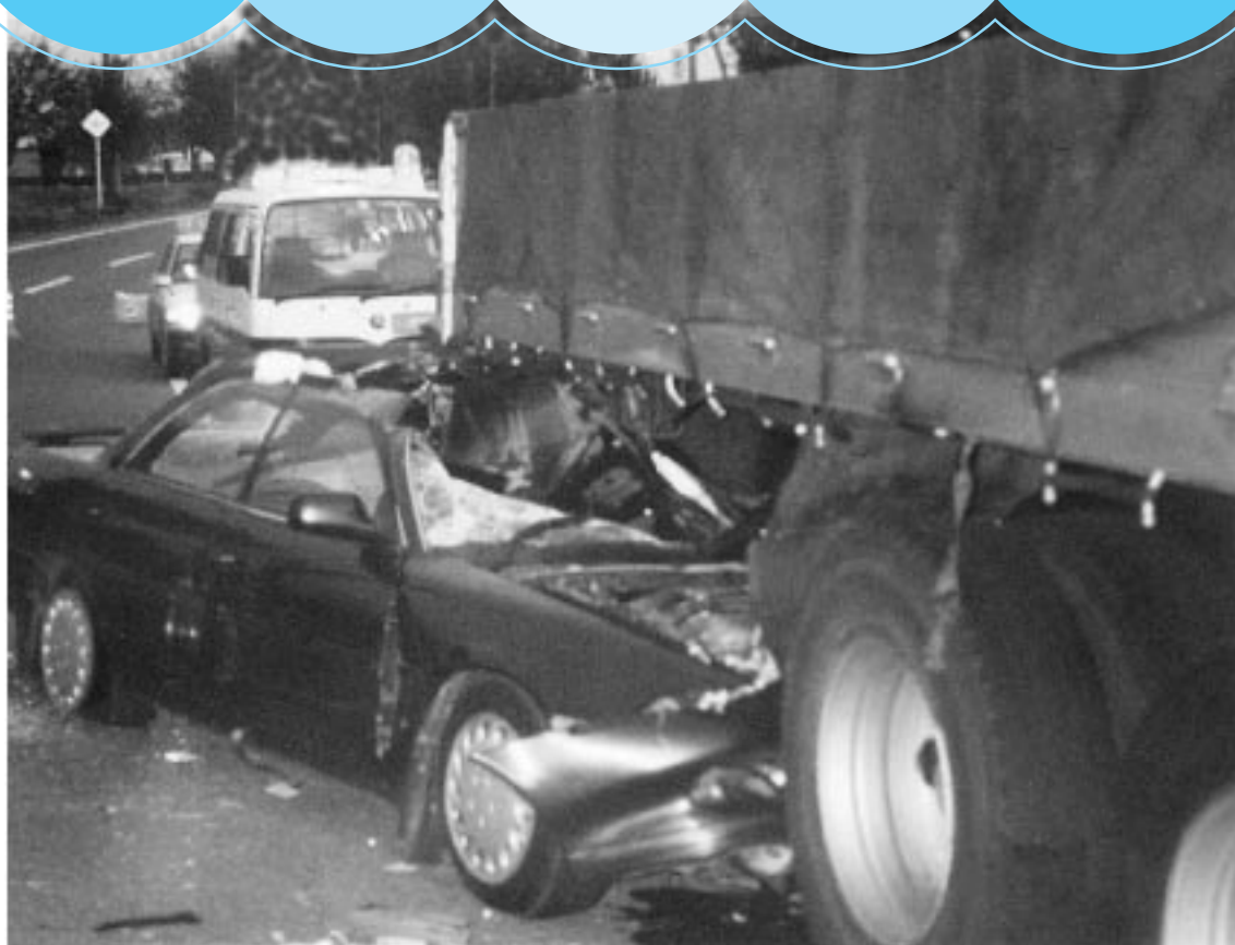
写真1 貨物車に追突した普通乗用車 (事故直後の状況)
