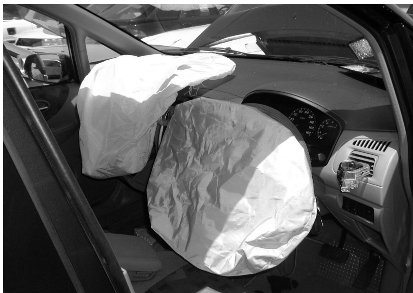
衝突により作動した運転席エアバッグと助手席エアバッグ
