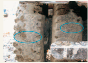
写真3 左後輪タイヤの摩耗状況
