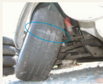
写真2 左後輪タイヤの摩耗と損傷状況
