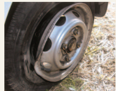
写真1 左後輪タイヤ損傷状況
