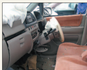
写真6 A車室内 縮小変形有り(小)
