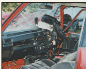
写真10 A車室内 縮小変形有り(大)
