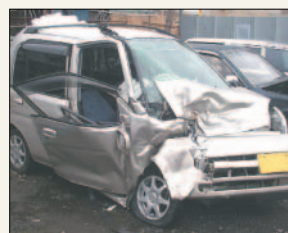
写真7 B車外観 フロントドアまで損傷有り
