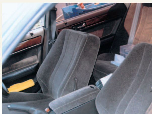
図15 事故例3のBではヘッドレストが外されていた
