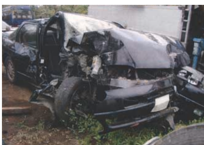
写真7 A車の車体変形状況
