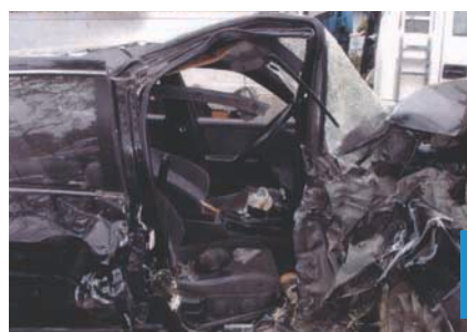
写真8 A車の運転席の損傷状況
