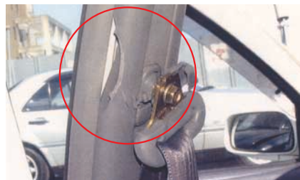
写真2 A車の助手席シートベルト 上部取付部付近の破損状況
