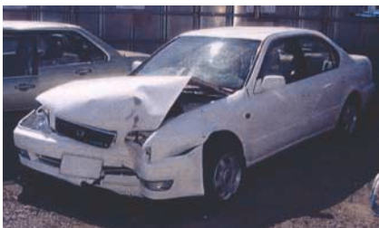
写真1 A車の車体変形状況
