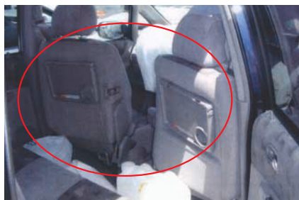
写真6 B車の前席シートバック変形状況
