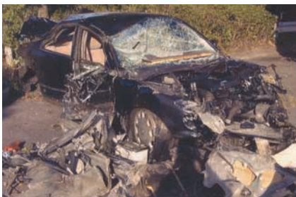
写真3 A車の車体変形状況
